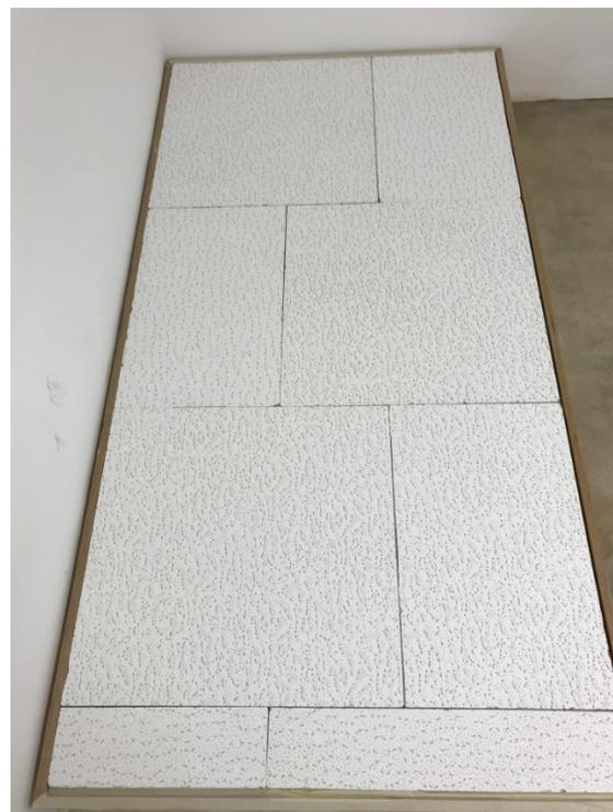
Abbildung 6: Prüfkörper im Hallraum-Umfassungsrahmen, Probe 90100359 II b
