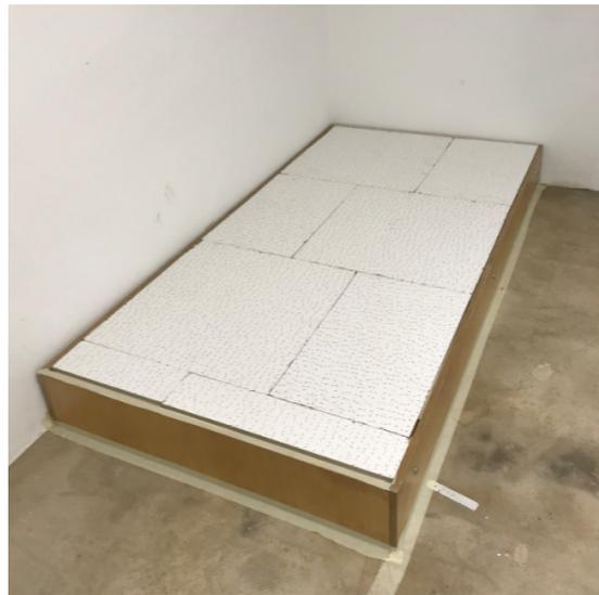
Abbildung 2: Prüfkörper im Hallraum-Umfassungsrahmen, Probe 90100359 II a
