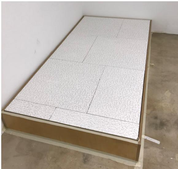
Abbildung 1: Prüfkörper im Hallraum-Umfassungsrahmen, Probe 90100359 I a
