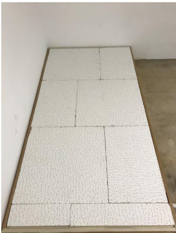
Abbildung 5: Prüfkörper im Hallraum-Umfassungsrahmen, Probe 90100359 II a
